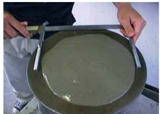
⑧広がった径の最大の方角とこれに 直角な方向をスケールで測りその平均値 をフロー値とする。
