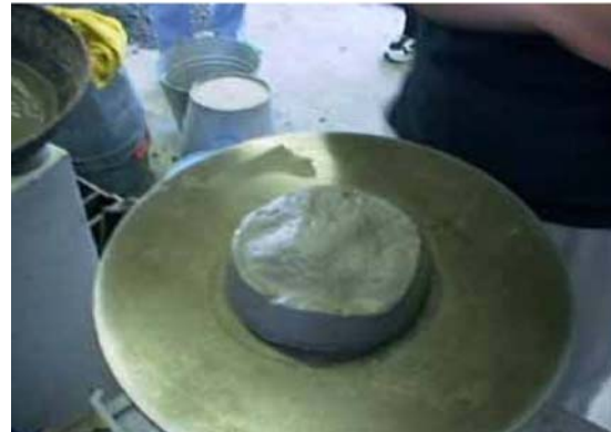
⑥フローコーンを静かに上方に 引き抜く。
