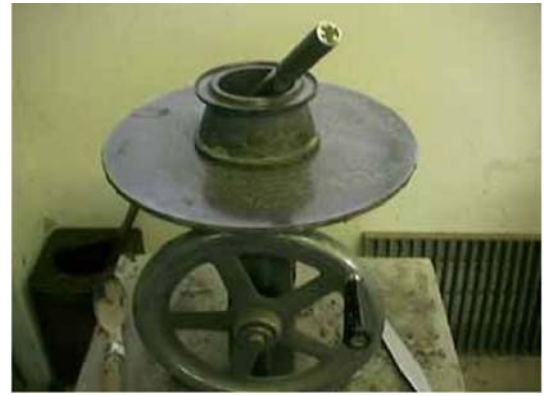
④型枠の汚れを落とし、破損がないか確認しグリスを十分に塗る。
